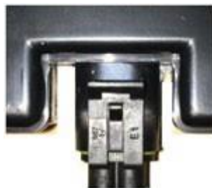
Figure 5: Korrekt angeschlossener PSU-Steckverbinder Clip
